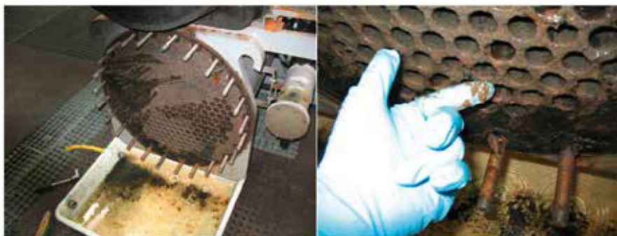
Biofilmbildung an Rohrbündelwärmeübertrager mit Detailaufnahme. Kommentar zur Richtlinienreihe VDI 2047, Bild 16.
